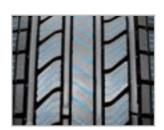
углами снижают уровень шума при движении на высоких скоростях и обеспечивают лучшую управляемость.
